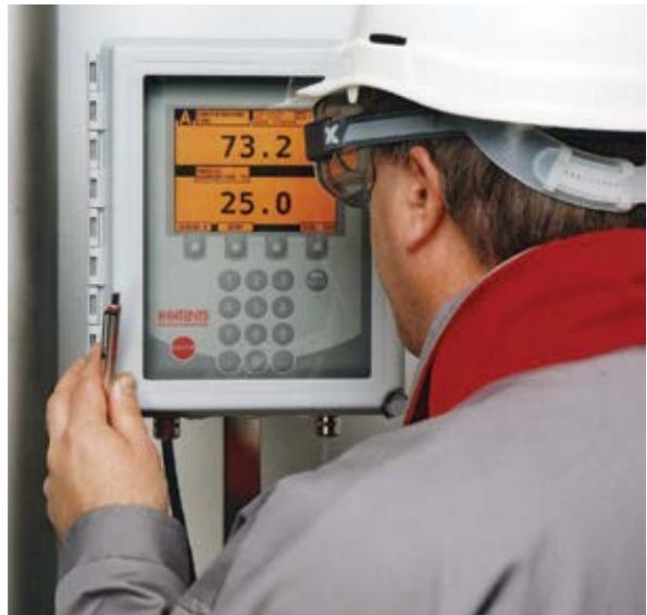
K-PATENTS PROCESS REFRACTOMETER PR-23-GP
